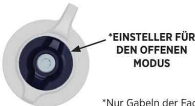
Der **\*Einsteller für den OFFENEN Modus** ermöglicht, das Federverhalten der Gabel bei Verlagerungen des Fahrergewichts, beim Springen und bei langsamer Krafteinwirkung zu steuern.
